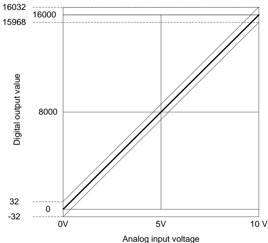
(1) Accuracy when using 5V input
